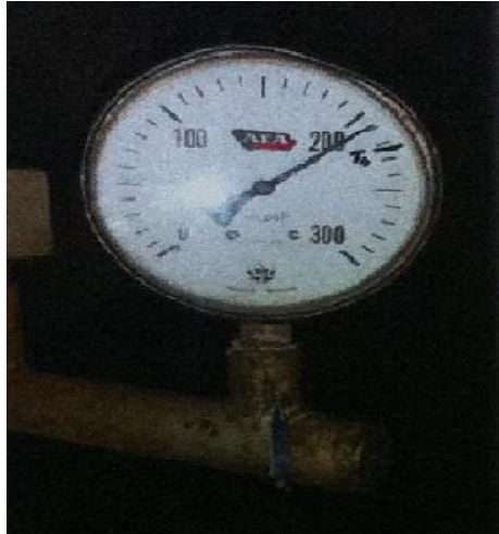
FIGURA 6- Pressão aplicada no teste hidrostático
